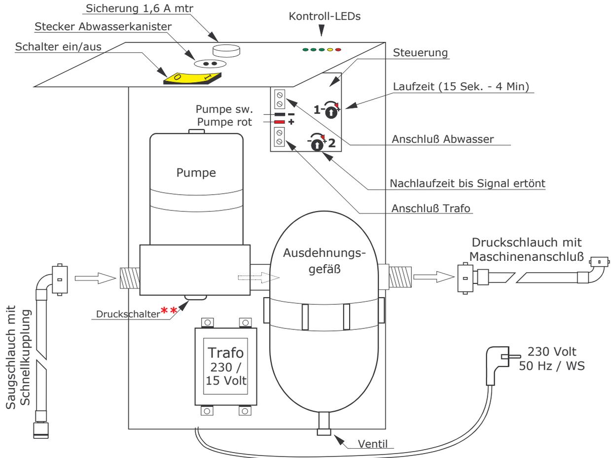
Die Wasserversorgung mobil innotec bietet die Möglichkeit Geräte, die einen festen Wasseranschluß benötigen, mobil zu betreiben. Die Pumpe ist auf einfachste Weise zu installieren, da sie vorgefertigt in einem Gehäuse montiert ist. Es müssen lediglich die beigefügten Schläuche montiert werden und der Anschluß an die Maschine oder einem anderen Gerät muß hergestellt werden sowie die Versorgung mit 230 Volt / Ws. muss sichergestellt sein.
